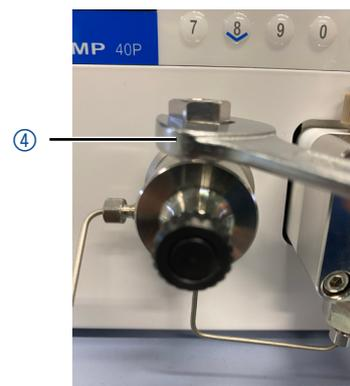
**Abb. 24:** Verschraubung lösen
