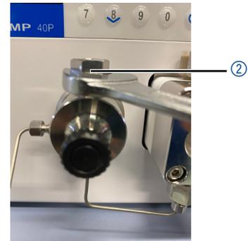
**Abb. 29:** Verschraubung festziehen
