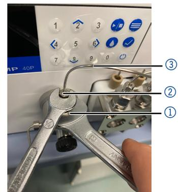
**Abb. 23:** Kapillare lösen
