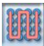
Spaltenweise (X-Richtung) im Wechsel von oben nach unten und unten nach oben. Kurzer Weg beim Wechsel der Spalte.
