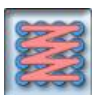
Reihenweise (Y-Richtung) immer von links nach rechts. Langer Weg beim Wechsel der Reihe.
