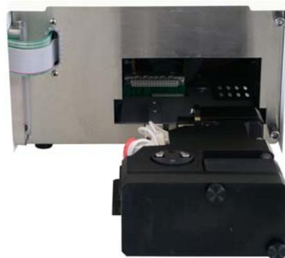
Abb. 43 Detektor mit herausgezogener optischer Bank
