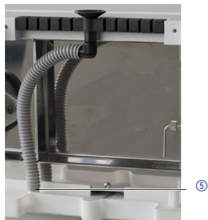
Abb. 10 Drainageschlauch am Gerät befestigen
